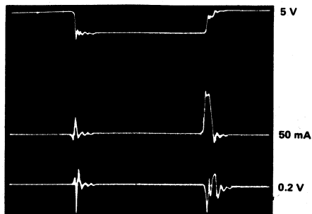
h) SN74AS1000 load: C_L = 50 \text{ pF}
